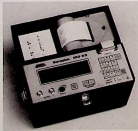
Bild 17: Impuls-Reflektometer Echopilot IRG 23 (Baur-Pressbild)
