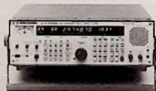
Bild 1: Der mikroprozessorgesteuerte Betriebs- und Suchempfänger EK 085 empfängt amplitudenmodulierte Signale, Einseitenbandsignale, Morsezeichen sowie Fernschreib- und Wetterkartensendungen und kann stationär oder auf Schiffen und Fahrzeugen betrieben werden.
