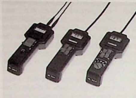
Bild 26: Prüfgeräte für VDE-Schutzmaßnahmen (Hartmann & Braun-Pressbild)
