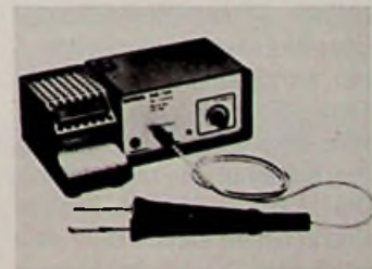
Bild 1: Entlötgerät für SMD-Bauelemente (ERSÄ-Pressbild)
